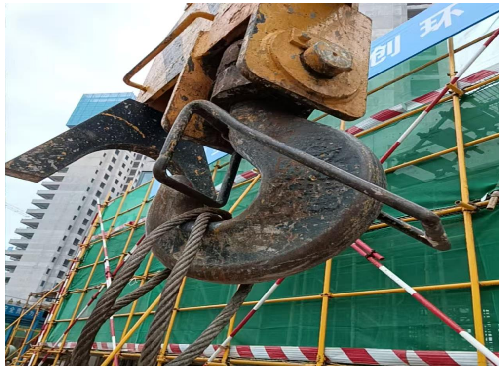
塔吊设置自重式吊钩防脱落装置
